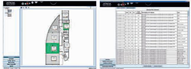
Im Standard kann die Software den Verbrauch prozentual bestimmen, jedoch bisher ohne Bezug zu einem Stromzähler. Dazu muss pro Ausseneinheit ein Zähler installiert werden. In der Software wird jedem Modbus-fähigen Zähler eine IP-Adresse vergeben und dementsprechend dem System zugeordnet. Wir empfehlen den Zähler 7KM PAC3200 von Siemens.
