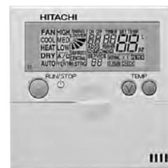
Kabel-Fernbedienung mit Flüssigkristallanzeige
