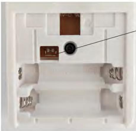
Schnitt (Achtung: Batterie vor dem Durchtrennen entfernen. Nicht unter Spannung schneiden.)
