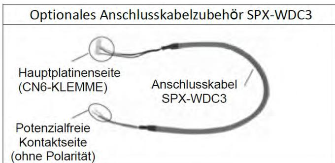
Zum Nutzen des Sperrsignals (z. B. als Fensterkontakt) muss die Anlage zunächst eingeschaltet sein. Das Schließen der 2 Kontakte führt den Sperrbefehl aus (oder entsperrt falls ausgewählt). Nach öffnen geht die Anlage wieder in Betrieb wenn sie zuvor eingeschaltet war.
