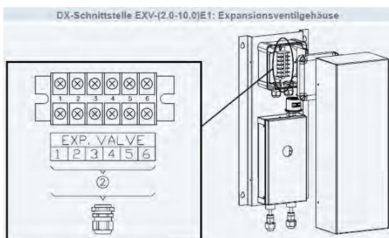
Verbindungsleitung zum E-Ventil 6 Adern 6x 0,5mm<sup>2</sup>
