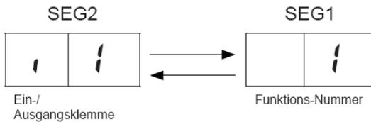
Durch wiederholtes drücken der Taste PSW2 wechselt die Anzeige zu der jeweiligen Funktion. Die Zahl die daneben steht, ist der dazugehörige Wert. Durch Drücken der Taste PSW1 wechselt der eingestellte Wert der Funktion. Zum Speichern der Parameter brauchen nur die beiden DIP-Schalter zurückgesetzt werden. Stellen sie dazu Pin 6 von DSW2 auf Off. Danach Pin 4 von DSW1 auf Off.
