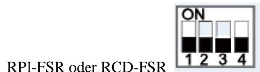
RCI-FSR Nur bei kombination mit der Silent Iconic Blende wird DSW9 pin 3 auf ON gestellt
