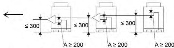
Wenn der Anschluss-Kit auf einer höheren Ebene als der Anschluss der Kältemittelrohrleitungen des Außengeräts positioniert wird, einen Höchstabstand von 300 mm zwischen Anschluss-Kit und Boden des Außengeräts einhalten. Außerdem muss zwischen Anschluss-Kit und Außengerät ein Ölwarmer -A- (mindestens 200 mm) installiert werden.
