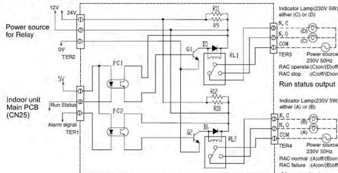
Optionale (Bauseitige) Spannungsversorgung DC 12V oder 24V
