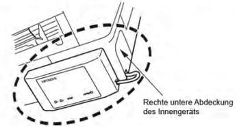
(7) Setzen Sie den ② Befestigungsclip ein und klemmen Sie ihn an der rechten unteren Abdeckung des Innengeräts fest.
