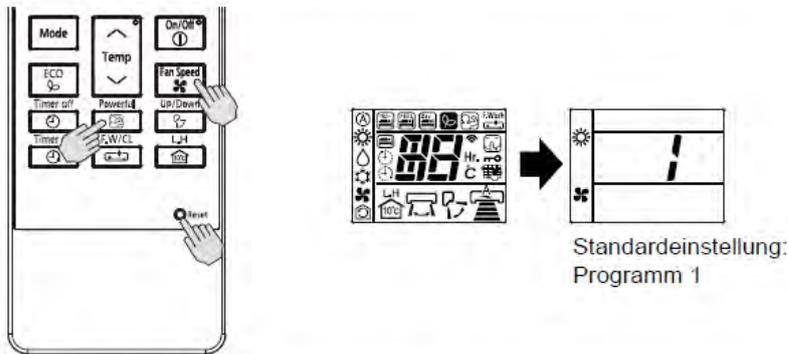
2. Drücken Sie die [RAUMTEMPERATUR-Einstellung]-[^(HÖHER)]/[V(NIEDRIGER)]-Tasten. (Das Intervallprogramm wird nach einem Signalton geändert.)
