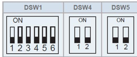
Pin 1 von DSW4 oder DSW5 überbrückt die interne Sicherung (nur im Notfall schalten)
