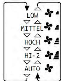
In der Betriebsart Kühlen, arbeitet der Lüfter immer auf der eingestellten Drehzahl. In der Betriebsart Heizen, arbeitet der Lüfter nur auf der eingest. Drehzahl, wenn die Anlage auch aktiv heizt (mit Vor- und Nachlaufzeit). Wenn die Anlage nicht heizt, arbeitet der Lüfter nur auf kleiner Drehzahl (bzw. ist ganz aus).
