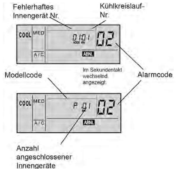
Bei allen Modellen mit IR Fernbedienung **blinkt die Betriebs-LED dauerhaft**, wenn ein Fehler angezeigt wird. Der Fehler-Code selbst wird über die anderen LEDs durch Blinkintervalle dargestellt.
