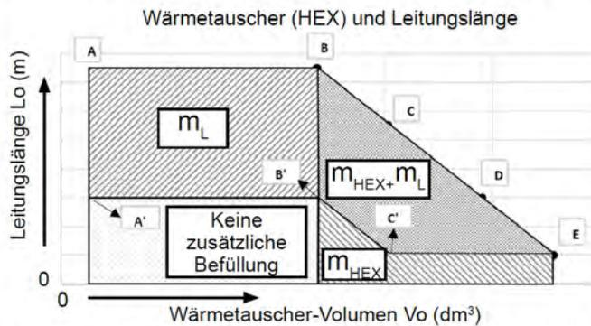
Das Ausdehnungsvolumen des Wärmetauschers ist auf gewisse Anwendungen beschränkt. Für diese Anwendungen, bei denen das Standardvolumen nicht zulässig ist und Leitungseinschränkungen gelten.
