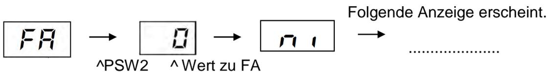
Durch wiederholtes drücken der Taste **PSW2** wechselt die Anzeige zu der jeweiligen Funktion. Die Zahl die als nächstes erscheint ist der dazugehörige Wert. Durch drücken der Taste **PSW1** wechselt der Wert der Funktion. 1= aktiv 0= nicht aktiv. (**Werkseinstell. = 0**)
