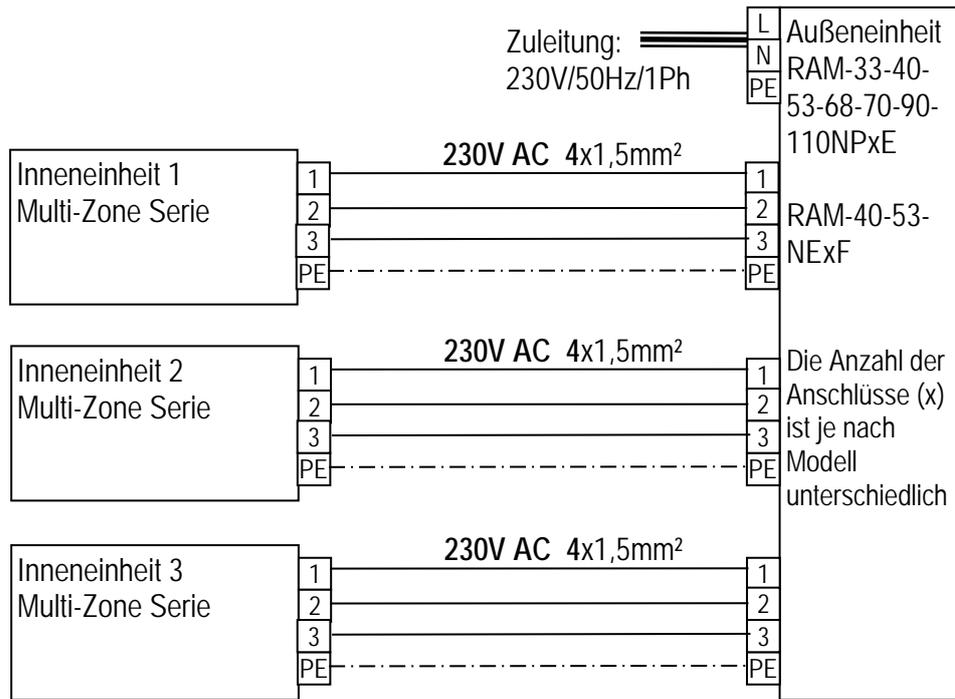
Jede Inneneinheit wird immer einzeln (elektrisch und kältetechnisch) angeschlossen. Das Außengerät erkennt selbständig welches Innengerät angeschlossen wurde.
