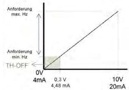
Bei Utopia wird die Verdichter Drehzahl nur innerhalb des möglichen Regelbereiches des Verdichters angepasst (sollte die kleinste mögliche Verdichter Drehzahl erreicht sein, wird diese gehalten). Die bestmögliche Regelung wird mit den Sondermodellen Utopia RAS-XH(V)NP(1)E (nur Single 100%) erzielt.
