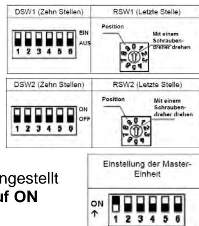
Sollten **ein oder mehrere** Inneneinheiten auf einem Kältekreislauf eingestellt sein, **muß ein Gerät** als Master konfiguriert werden. **DSW3 Pin 1 auf ON** (Rest OFF).
