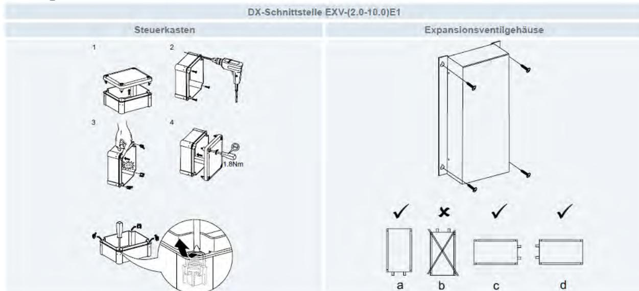
Schaltkasten IP 66 / Achtung: um den Deckel zu montieren müssen die beigeigten Klipse in das Gehäuse eingesetzt werden.
