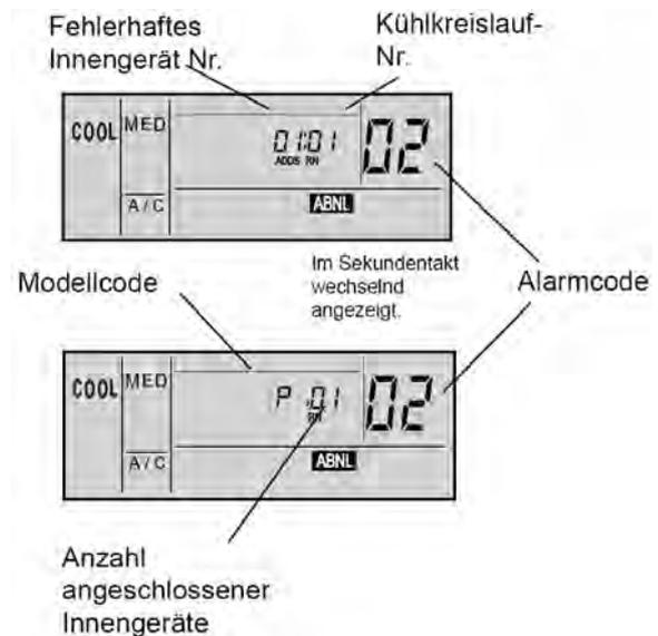
Fehlerhaftes Innengerät Nr.      Kühlkreislauf-Nr.
