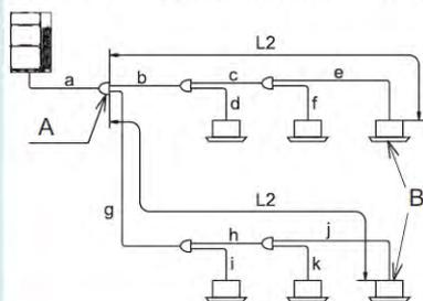
Die Leitungslänge zwischen dem Multi-kit an der ersten Abzweigung bis zum letzten Innengerät liegt innerhalb von 40 bis 90 m.
