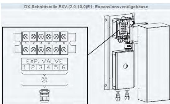
Verbindungsleitung zum E-Ventil 6 Adern 6x 0,5mm<sup>2</sup>
