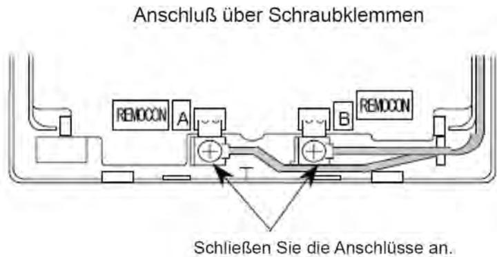
**ACHTUNG !!!** Nur bei **Wandgeräten** RPK-xxFSN3M (werkseitig für IR Empfänger eingestellt) muss zusätzlich der Schiebeschalter SW2 auf (Wired) gestellt werden. Ansonsten zeigt die Kabelfernbedienung zwar was an, das Gerät funktioniert aber nicht richtig.
