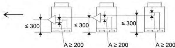
Wenn der Anschluss-Kit auf einer höheren Ebene als der Anschluss der Kältemittelrohrleitungen des Außengeräts positioniert wird, einen Höchstabstand von 300 mm zwischen Anschluss-Kit und Boden des Außengeräts einhalten. Außerdem muss zwischen Anschluss-Kit und Außengerät ein Ölvorwärmer -A- (mindestens 200 mm) installiert werden.
