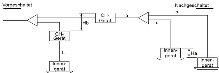
Bedingung bei Verlegung der Leitungen
