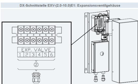
Verbindungsleitung zum E-Ventil 6 Adern 6x 0,5mm<sup>2</sup>
