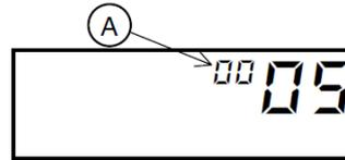
Wenn die in Teil (A) angezeigte Zahl „99“ ist; wird die Prüfung nicht fortgesetzt.
