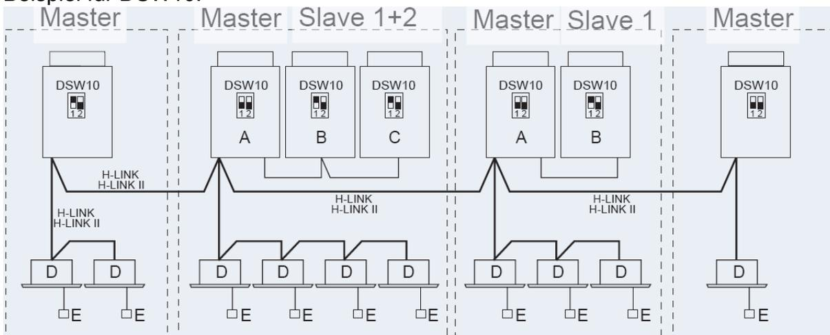
Mehrere Kältekreisläufe in einem H-Link. Eine Master Einheit Pin1 auf ON. Bei allen weiteren Geräten muss Pin 1 auf OFF gestellt sein. Bei Slave Geräten (B oder C) bleibt der Pin1 immer auf ON
