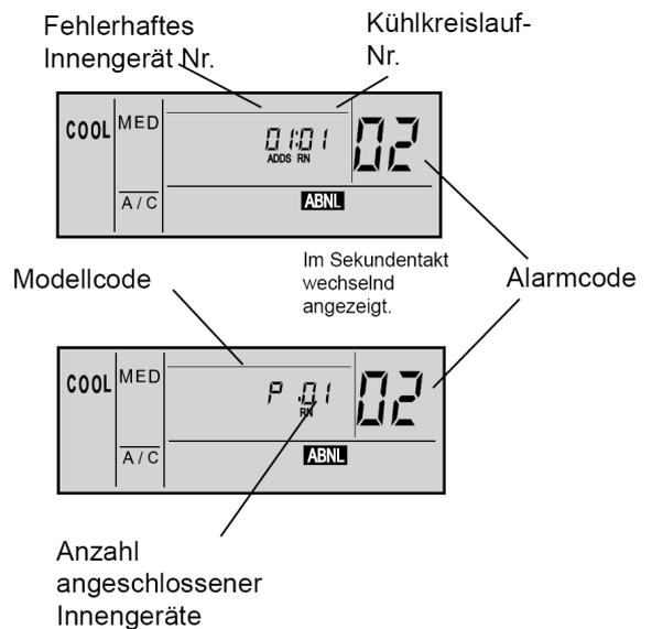
Fehlerhaftes Innengerät Nr.      Kühlkreislauf-Nr.
