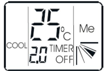
**Beispiel:** Einstellung Kühlen / Lüfterstufe Mittel / Sollwert 25°C / Anlage schaltet nach 2 Stunden automatisch ab.
