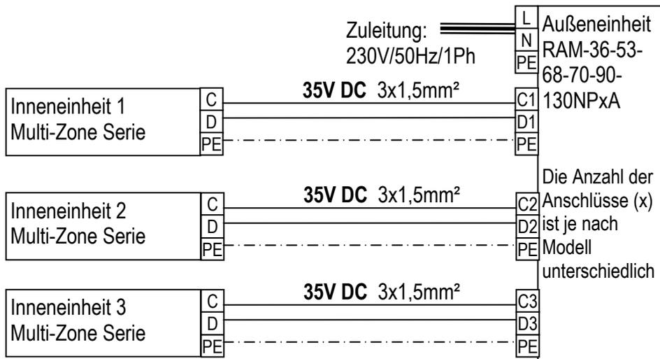
Jede Inneneinheit wird immer einzeln (elektrisch und kältetechnisch) angeschlossen. Das Außengerät erkennt selbständig welches Innengerät angeschlossen wurde.
