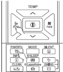
■ Methode zum Sperren des Modus HEIZEN (einschließlich VENTILATOR)
