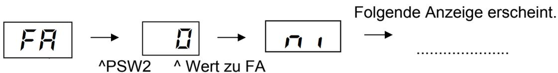
Durch wiederholtes drücken der Taste **PSW2** wechselt die Anzeige zu der jeweiligen Funktion. Die Zahl die als nächstes erscheint ist der dazugehörige Wert. Durch drücken der Taste **PSW1** wechselt der Wert der Funktion. 1= aktiv 0= nicht aktiv.
