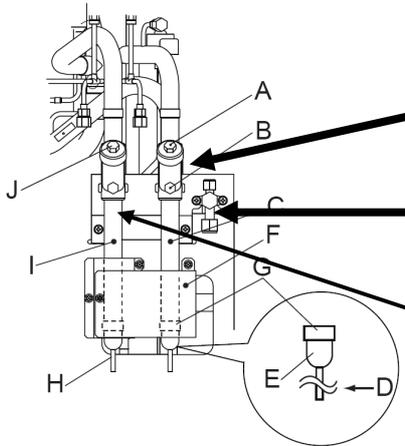
Der **mittlere** Anschluß ist die **Saugleitung** im Kühlmodus und Heißgasleitung im Heizmodus
