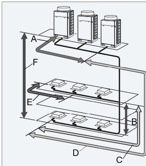
A. Außengeräte. Maximale Leitungslänge: 10 m. Höhenunterschied: 0,1 m.
