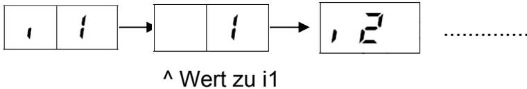
Durch wiederholtes drücken der Taste PSW2 wechselt die Anzeige zu der jeweiligen Funktion. Die Zahl die als nächstes erscheint ist der dazugehörige Wert. Durch drücken der Taste PSW1 wechselt der eingestellte Wert der Funktion.
