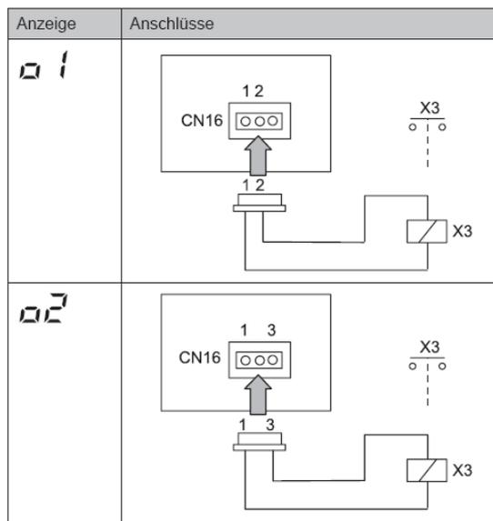
Die Pin-Belegung gilt für die entsprechenden Kontakt Nummer. z.B. i3 . = CN18 1-2. Jedem Kontakt kann eine spezielle Funktion zugeordnet werden.
