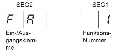
Durch drücken der Tasten PSW2 und PSW3 wechselt die Anzeige zu der jeweiligen Funktion. Durch drücken der Taste PSW1 wechselt der eingestellte Wert. 1= aktiv 0= nicht aktiv.
