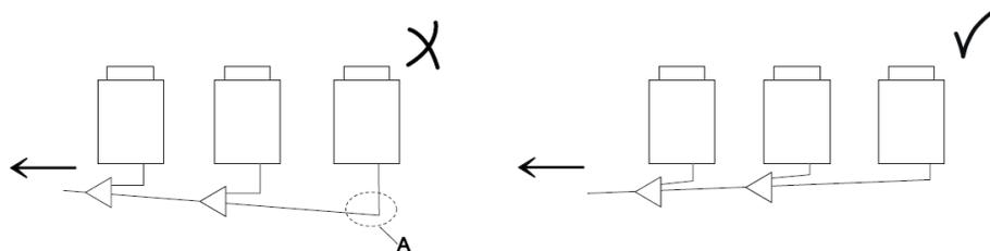
Die Kältemittelrohrleitungen der Außengeräte waagrecht oder leicht in Richtung Innengeräte geneigt verlegen, damit sich an der tiefsten Stelle -A- kein Kältemittelöl sammeln kann.
